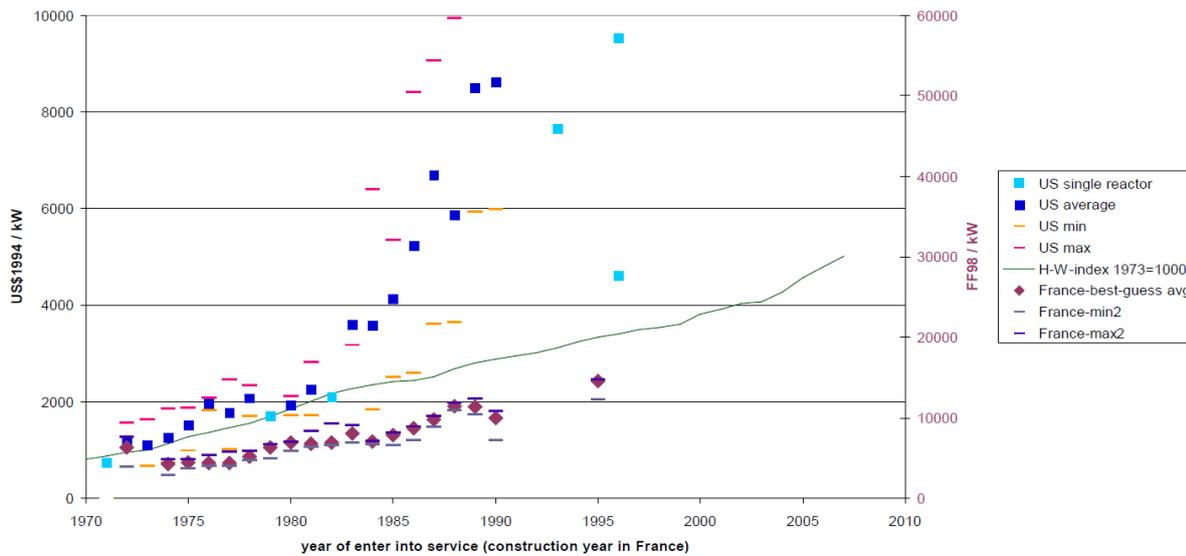
Quelle: (International Institute for Applied Systems Analysis 2009, S. 31), Die Y-Achse gibt die spezifischen Overnight Construction Cost in USD (1994) pro installiertem Kilowatt elektrischer Leistung und die X-Achse das Jahr der Inbetriebnahme (USA) bzw. des Baustarts (Frankreich) wieder.
